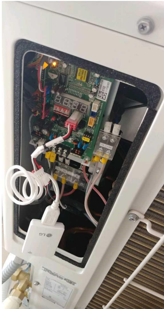
Multi V S 후면배관 (Mobile MV 연결 예시)
